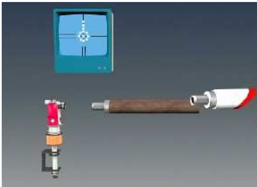
Az ábrán az irányítófej a diódás célkereszttel, a pilótarúd, a teodolit a videokamerával és a monitor látható
