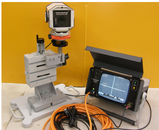
A Schmidt&Kranz cég által használt monitor, a teodolit-videokamera és a diódás megvilágítású célkereszt
